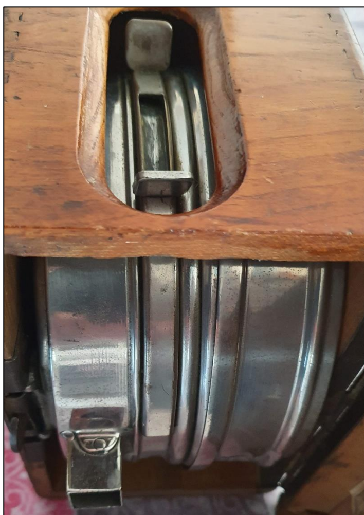
Mechanisme om het potje met ring in de vergaarbak (onderaan) te deponeren
